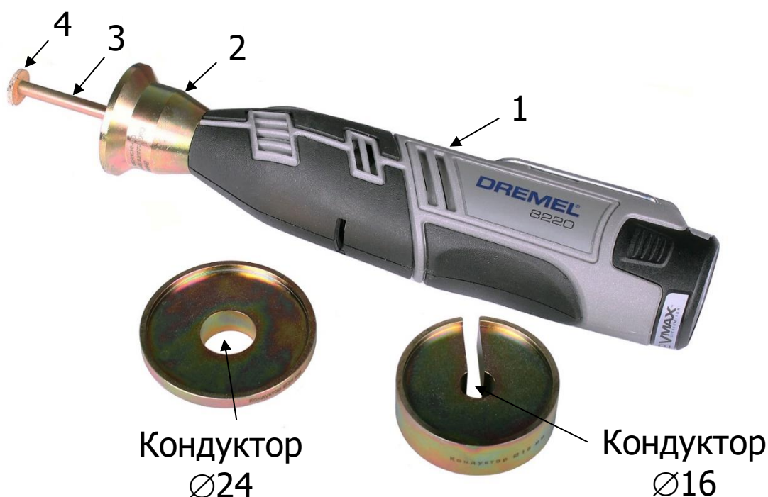
Рисунок 4 – Внешний вид расточного устройства с электроприводом и кондукторов
